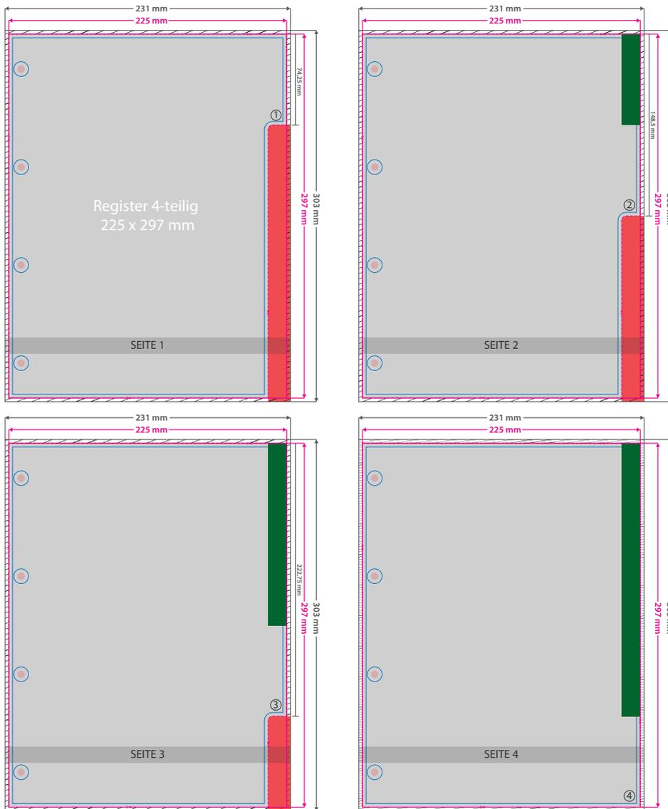
Sie können bei den Registern zwischen 2 und 4 Abheftlocher wählen. Bitte beachten Sie diese Positionen bei Ihrer Gestaltung. Der rot markierte Bereich wird in der Produktion ausgestanzt, der dunkelgrüne Bereich wird im geschlossenen Zustand von den davorliegenden Registertablen abgedeckt.
